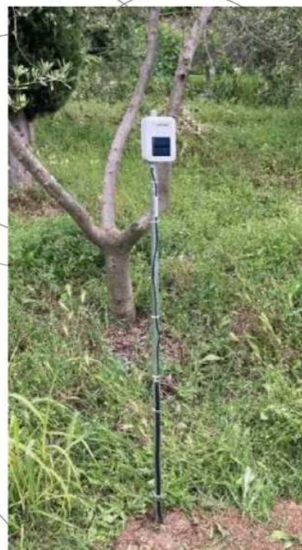
Sensore per rilievo dati di temperatura e umidità del suolo (parte infissa nel terreno)
