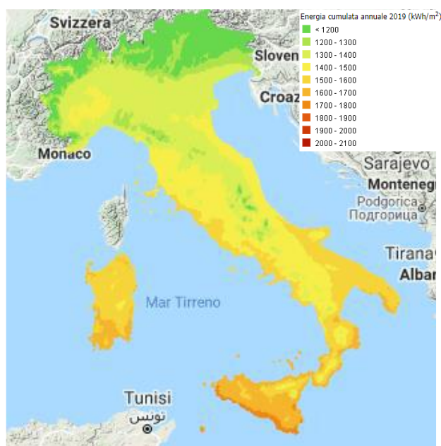
Figura 5.7 -Radiazione solare cumulata annua nel 2019 (Fonte: Elaborazione a cura di RSE su dati EUMETSAT http://sunrise.rse-web.it/ )
