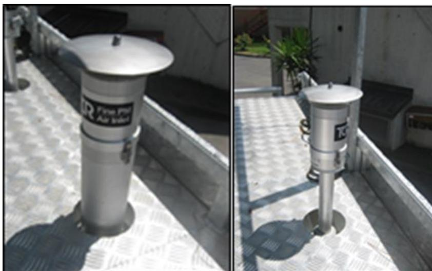
Figura 2-138 Teste di prelievo PM10 e PM2,5
