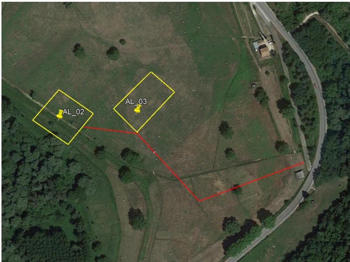
Figura 3-32 Sorgenti emissive simulate con il software Aermoc - Scenario 2 (AL\_02 e AL\_03 in giallo e ST\_01 in rosso)
