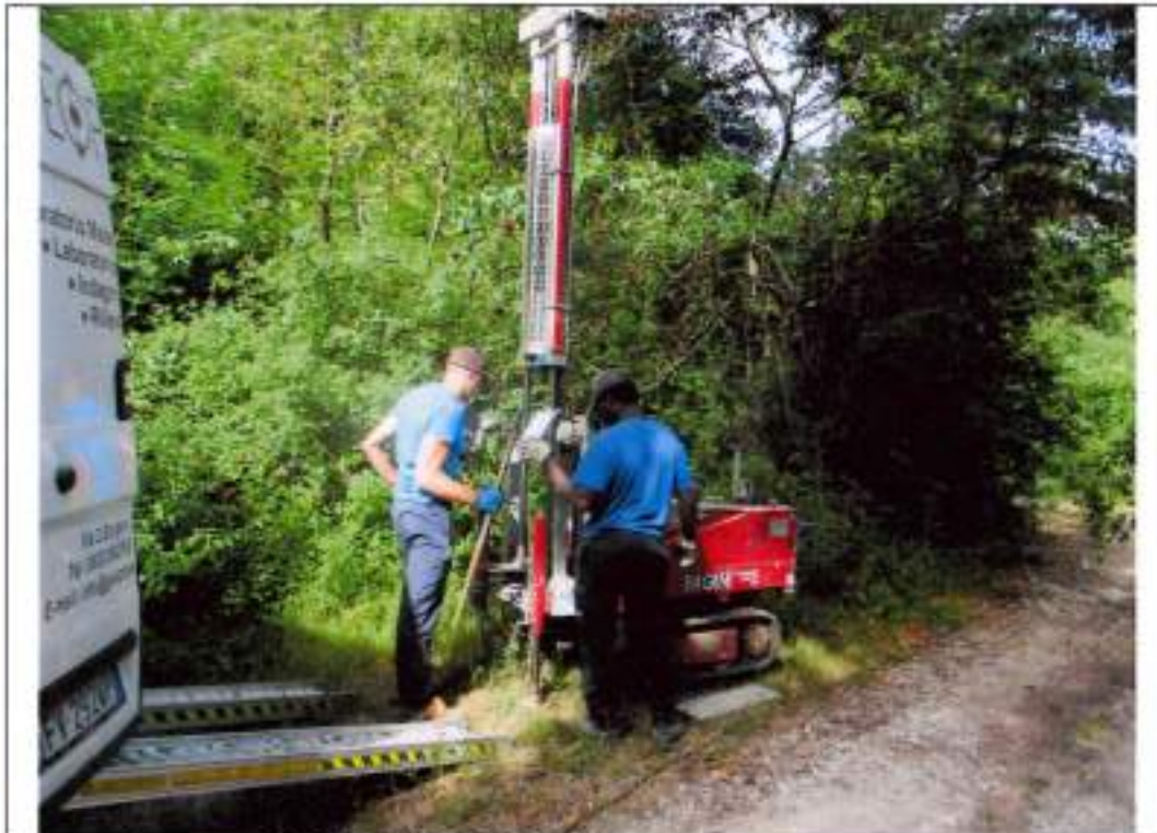
Esecuzione prova DPSHI TR4-PZ5
