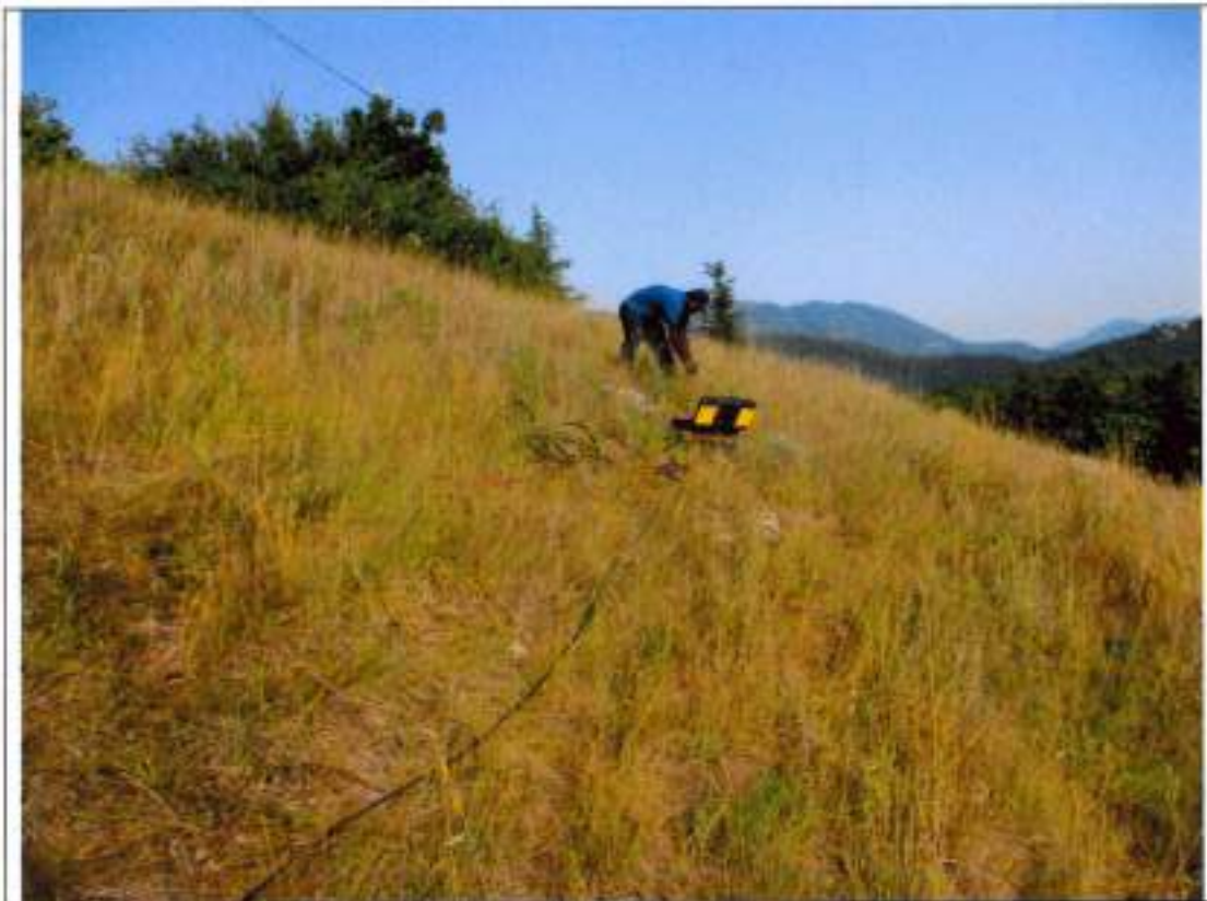
Esecuzione indagine sismica a rifrazione SR1
