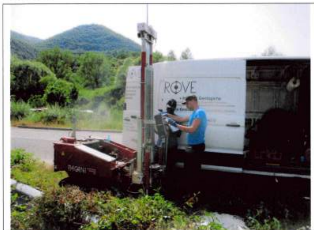
Esecuzione prova DPSH1 TR4-PZ2
