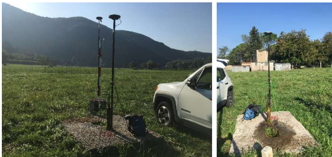
Figura 5: GPS in fase durante le fasi di acquisizione.
