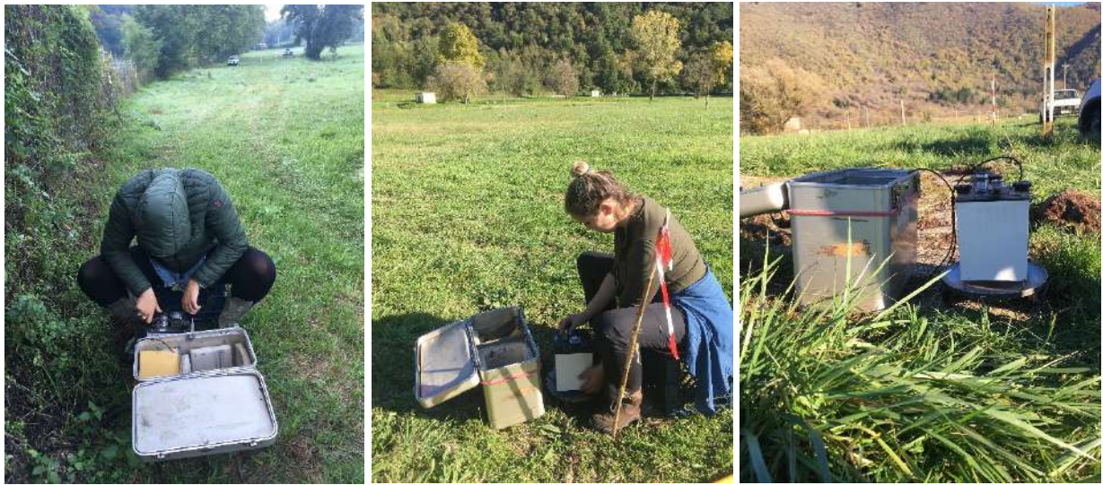
Figura 6: Gravimetro in misura su stazione gravimetrica
