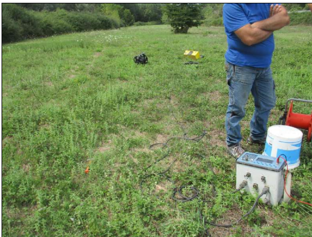
Fase di acquisizione dei dati geoelettrici
