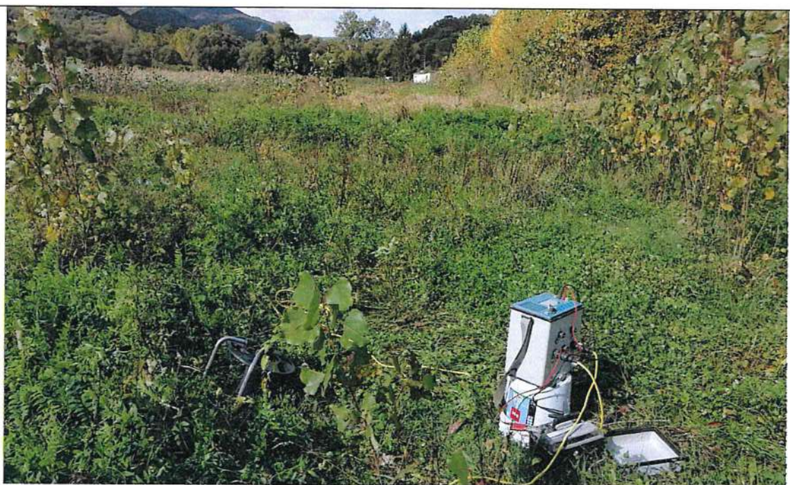
Esecuzione indagini elettrica 1-1'
