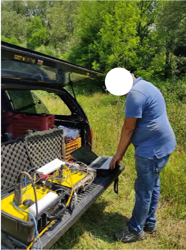
Acquisizione dati misure sismiche
