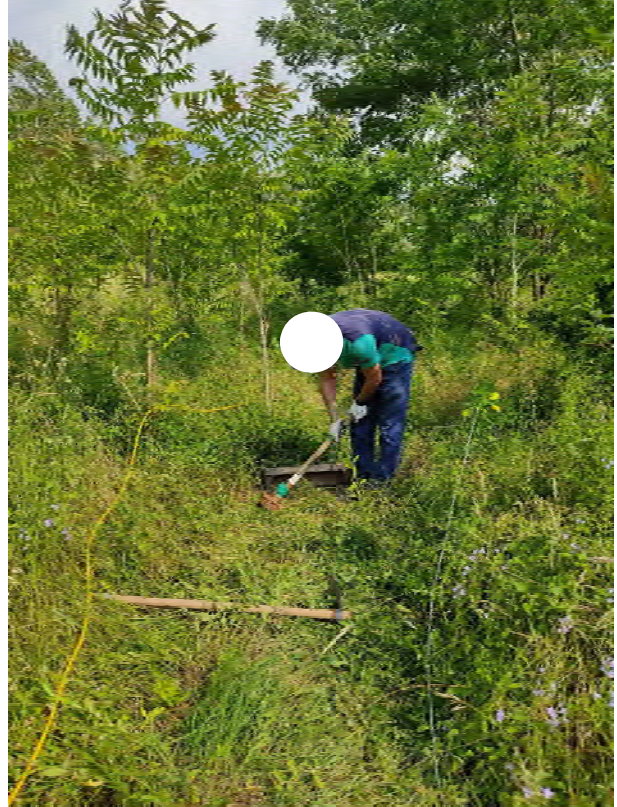
Energizzazione onde longitudinale (Onde P) con mazza battente onde longitudinale (Profilo sismica a riflessione)
