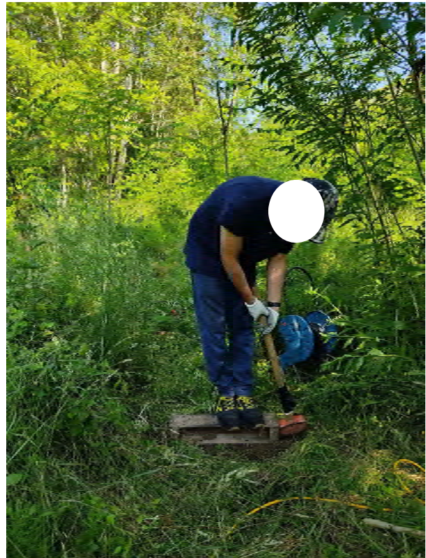
Energizzazione onde longitudinale (Onde P) con mazza battente onde longitudinale (Profilo sismica a riflessione)
