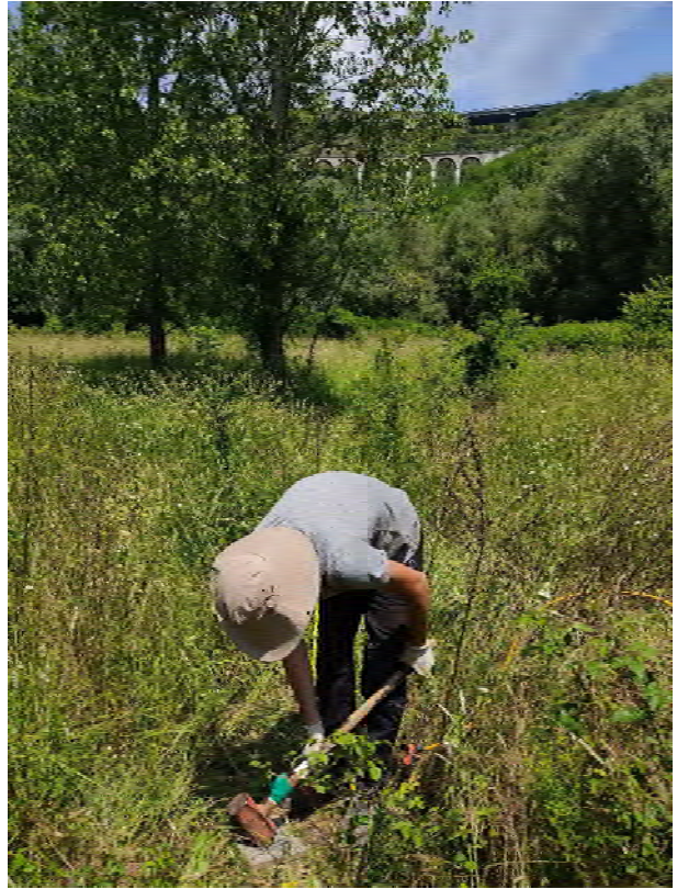
Energizzazione con mazza battente onde longitudinale (Onde P) - (Profilo sismica a rifrazione)
