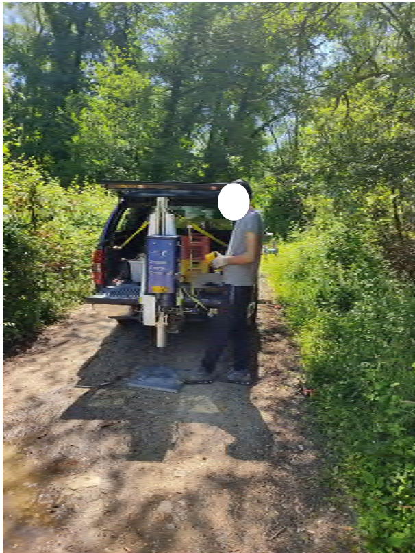
Energizzazione onde longitudinale (Onde P) con generatore ad energia propulsiva di onde sismiche “Peg40” (Profilo sismica a riflessione)
