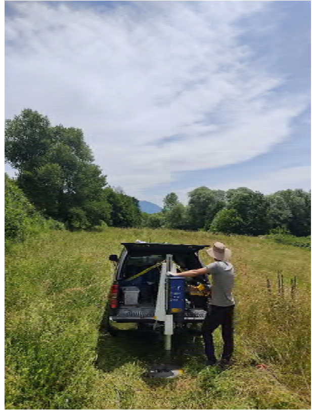
Energizzazione onde longitudinale (Onde P) con generatore ad energia propulsiva di onde sismiche “Peg40” (Profilo sismica a riflessione)
