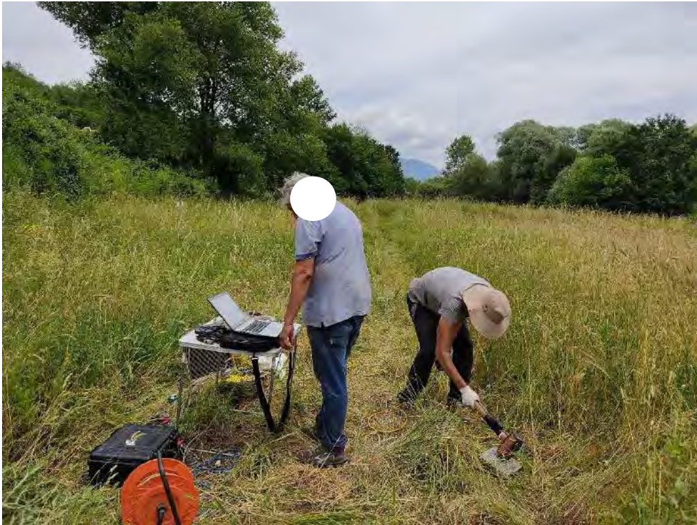
Energizzazione con mazza battente onde longitudinale (Onde P) - (Profilo sismica a rifrazione)
