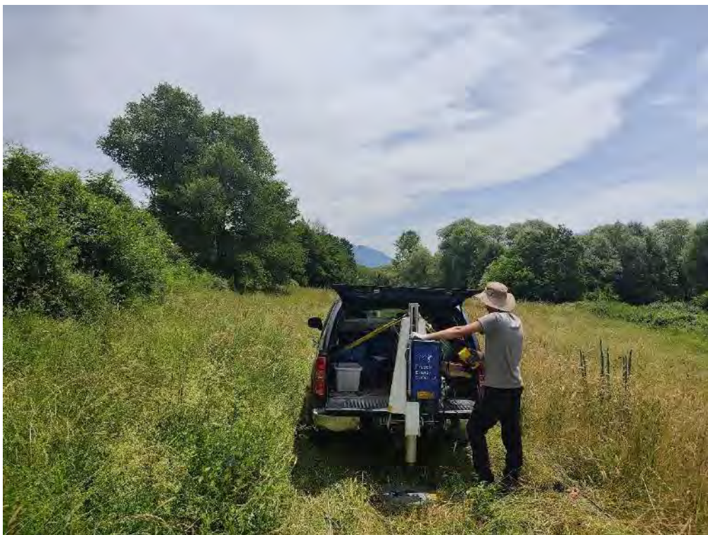
Energizzazione onde longitudinale (Onde P) con generatore ad energia propulsiva di onde sismiche “Peg40” (Profilo sismica a riflessione)
