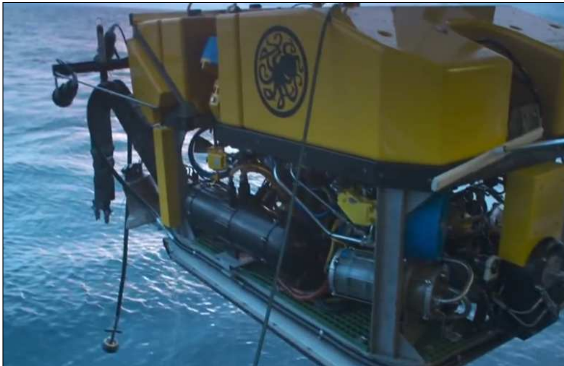
Figura 10.22 Remotely Operated Vehicle equipaggiato per recupero
