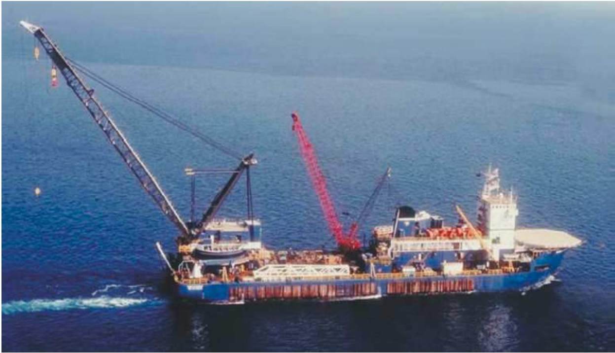
Figura 10-3 – Tipica Nave Gru con Gru a Braccio Mobile e Girevole
