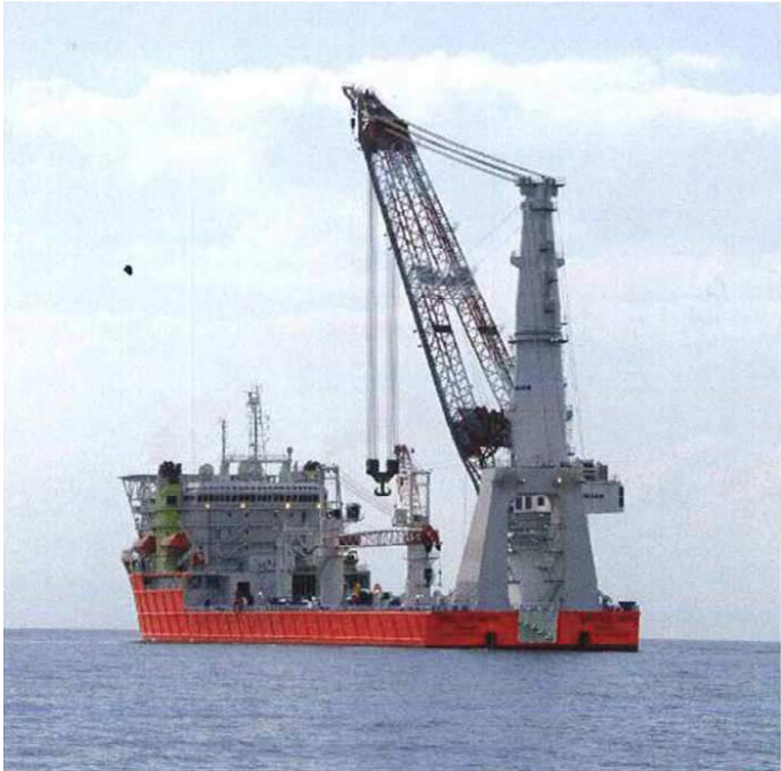
Figura 10-2 – Tipica Nave Gru con Gru a Braccio Mobile e Girevole
