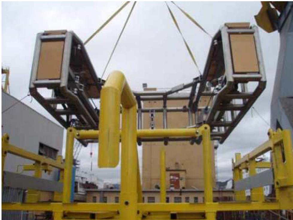
Figura 10-15 – Sistema di taglio DWCS per taglio a cavo diamantato - Tipico
