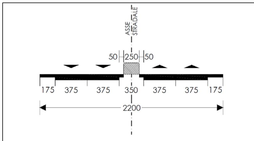
Nei tratti in rettilineo si mantiene la pendenza trasversale esistente, adeguando alla pendenza del 2,00 % le due fasce laterali di nuova realizzazione (ampliamento); nei tratti in curva, la pendenza trasversale esistente viene adeguata a quanto prescritto dalla normativa di riferimento, su tutta la larghezza della piattaforma stradale.
