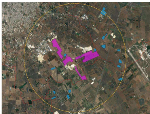
Figura 9 –Impianti FER (in azzurro) in esercizio/autorizzati nell'AVA in un raggio di 3km (Zona di Visibilità Tecnica) come riportato nello SIA 3
