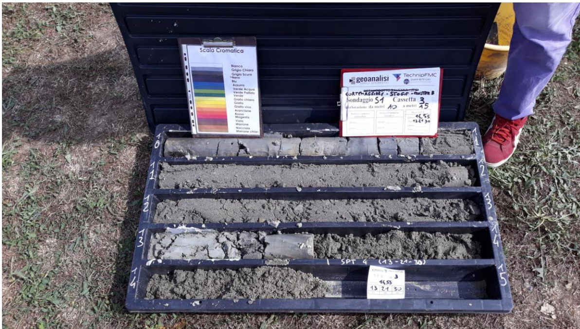
Fig. 10 – Sondaggio S1 cassa 3 (10-15m)
