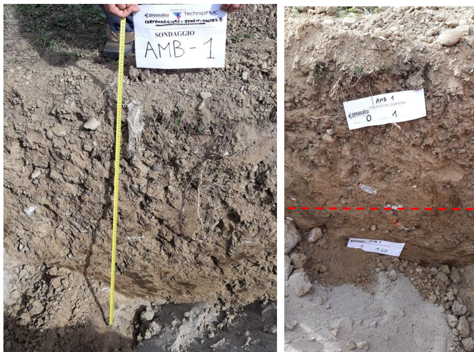
Fig. 16 – sondaggio AMB1, prof. 1,40m e individuazione punti di campionamento a parete
