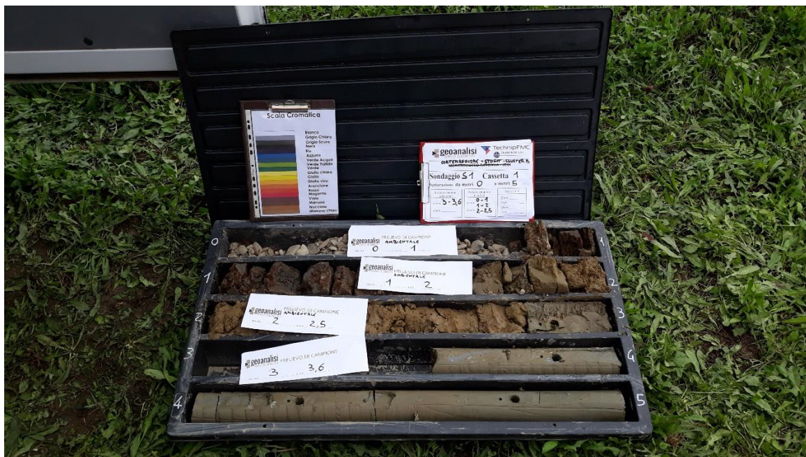
Fig. 9 – sondaggio S1 cassa 1 (0-5m)
