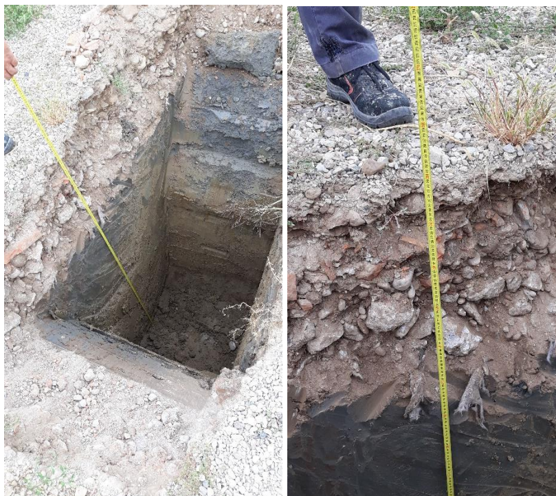
Fig. 18 – prescavo per sondaggio AMB2 / CPTU1, profondità 2,50m
