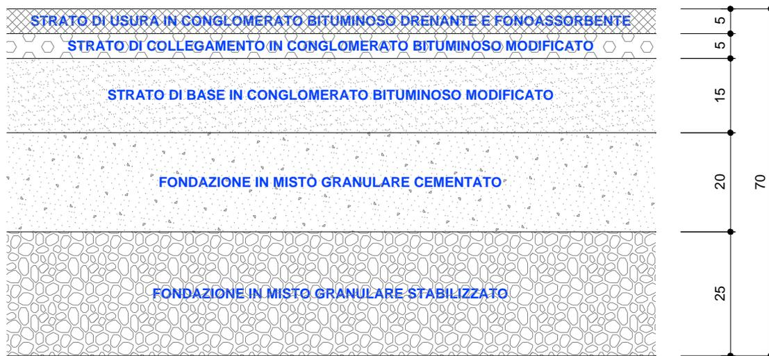
Figura 4-12 - Pacchetto pavimentazione
