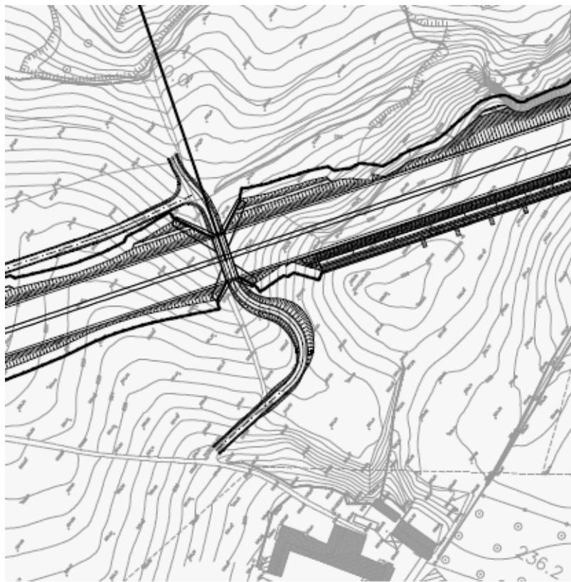
Figura 5-6 tratto di intersezione con il percorso alla progressiva 1+701 e riprogettazione della continuità
