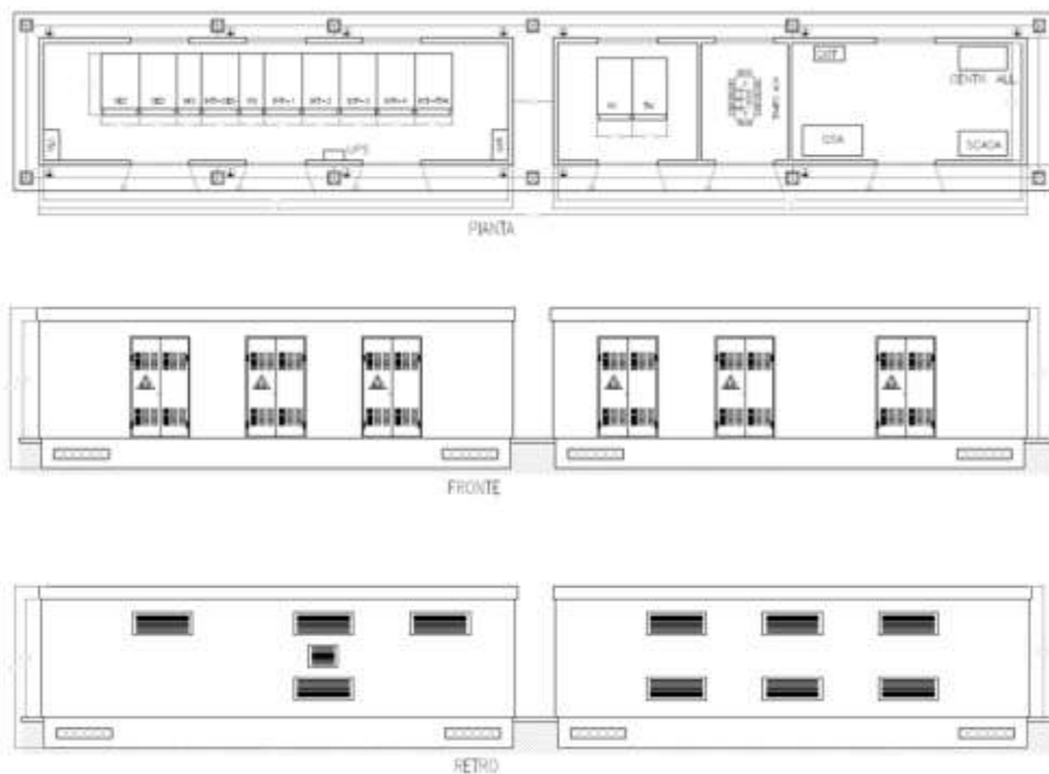
Figura 9. Tipologico della cabina di centrale.
