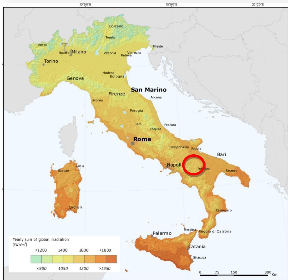
In relazione ai dati di input inseriti, delle perdite considerate ed a seguito dell'analisi svolta, si è stimata una produttività specifica dell'impianto fotovoltaico pari a **1.919 kWh/kWp anno**.
