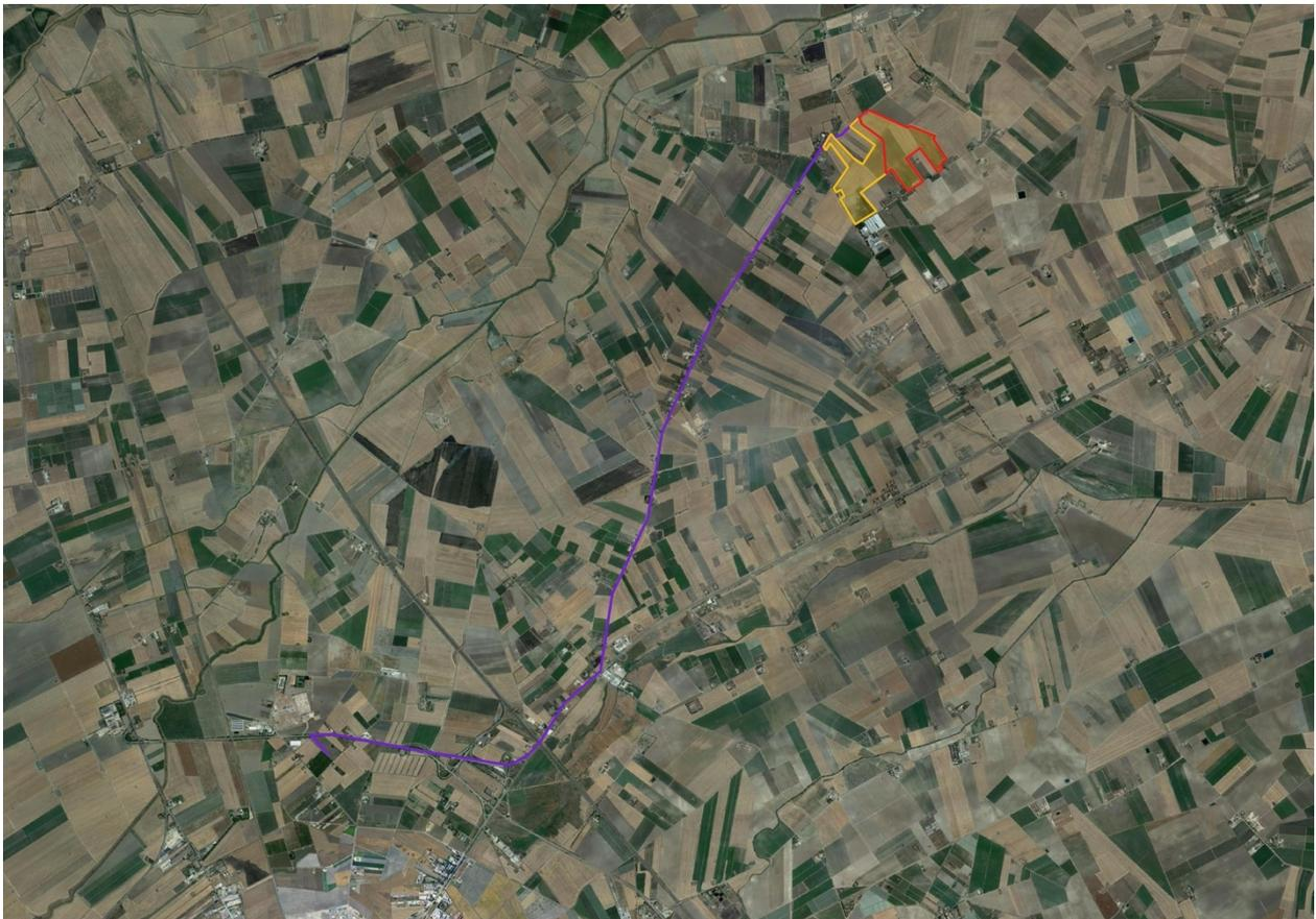
*Figura 2.1: Localizzazione dell'area di intervento, in giallo l'area contrattualizzata in rosso la recinzione dell'impianto, in viola la linea di connessione*
