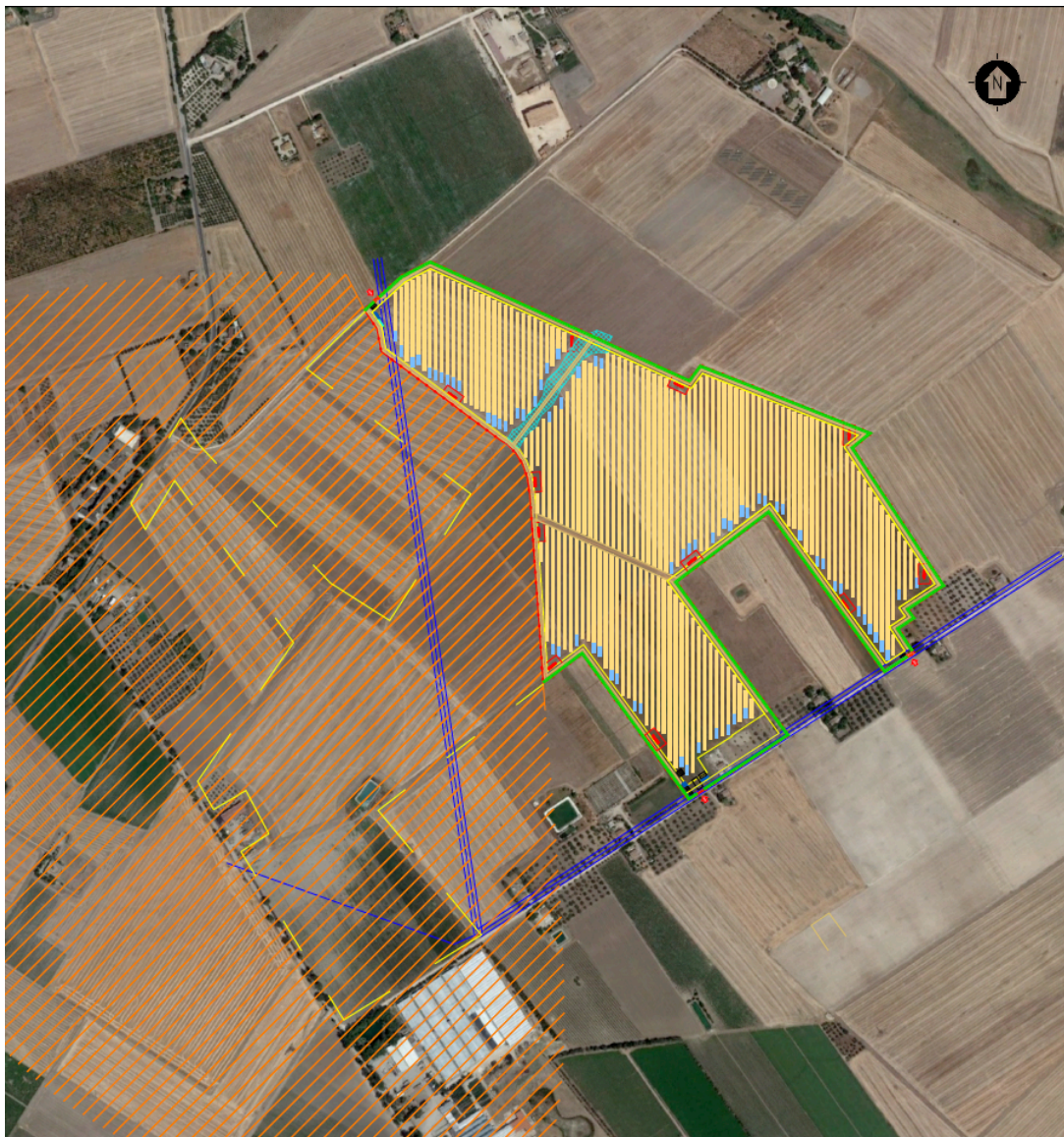
Figura 1: Localizzazione dell'area di intervento, in giallo l'area contrattualizzata in rosso la recinzione dell'impianto
