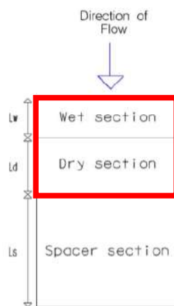
Figure 4.34: modulo tipo descrivente il modello concettuale idrologico dell'installazione di strutture fotovoltaiche a tracker su pari infissi comprendente l'area pannelli (in rosso) e l'area di interfila (Fonte: Hydrologic response of solar farm Cook 2013 American Society of Civil Engineers)
