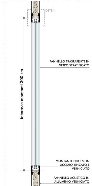
SEZIONE TIPO SU RILEVATO R/2.3 - scala 1:25
