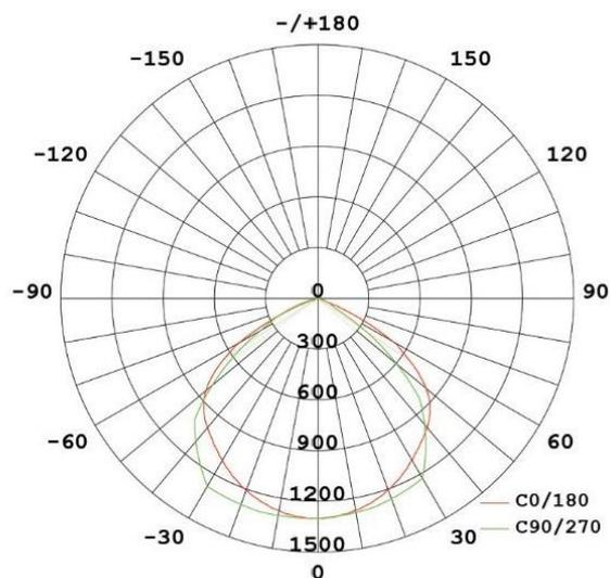
Figura 3.3 - Diagramma fotometrico e viste proiettore
