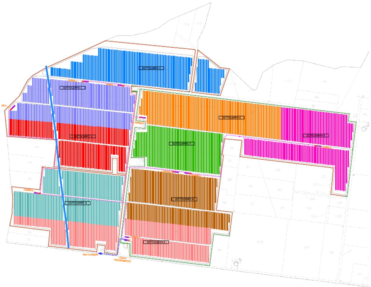
Figura 3.2 - Layout di progetto area impianto FV
