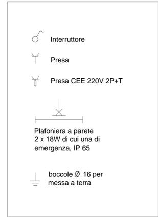
SCHEMA ELETTRICO UNIFILARE
