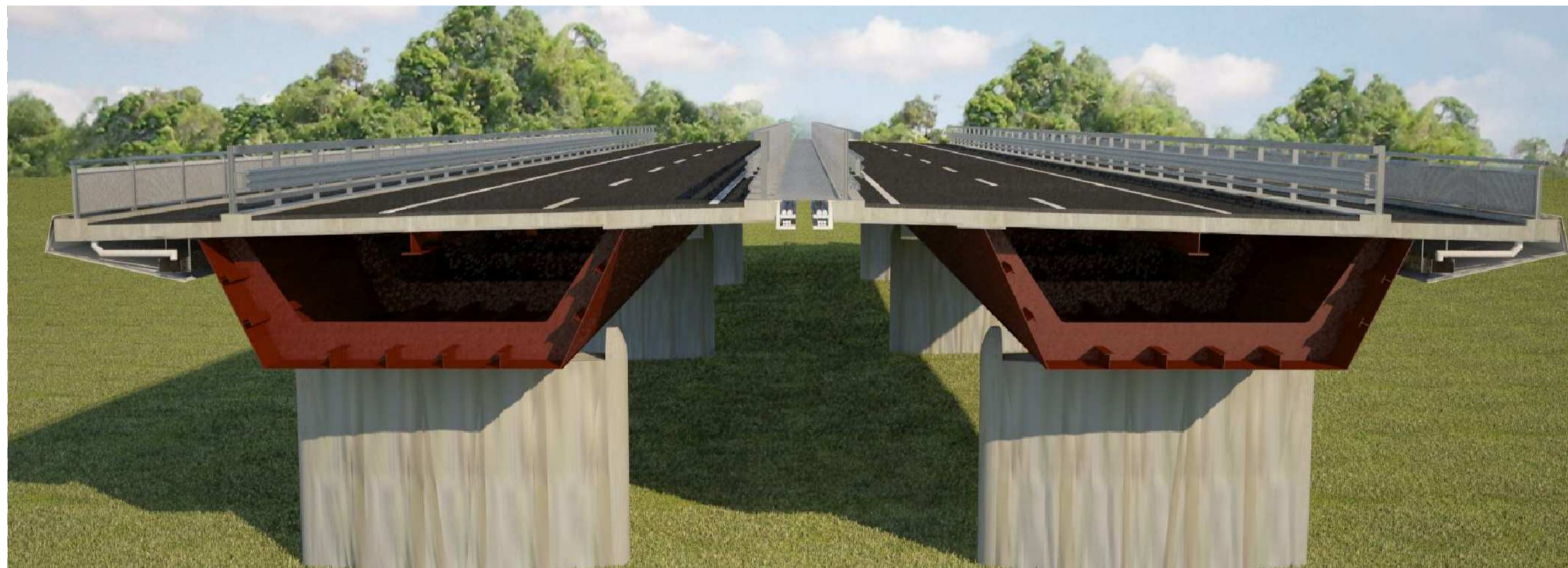
SIMULAZIONE - DETTAGLI IMPALCATO E CARTER METALLICO
