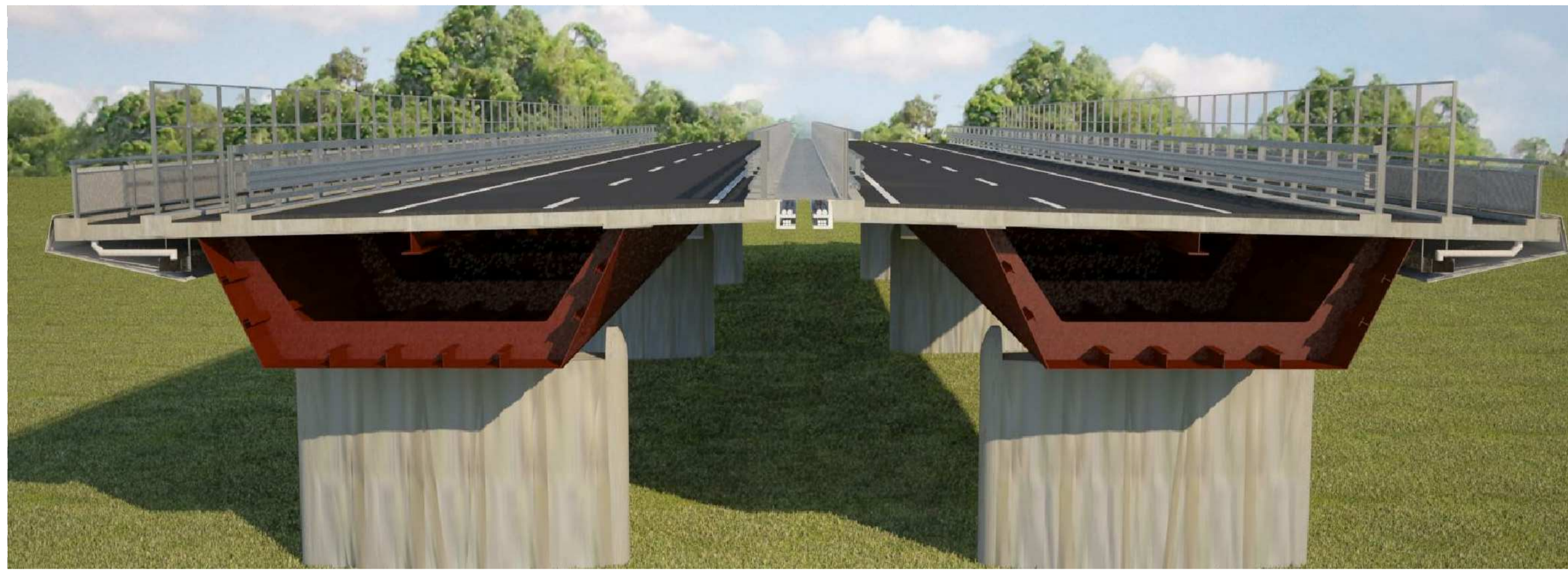
SIMULAZIONE - DETTAGLI IMPALCATO E CARTER METALLICO
