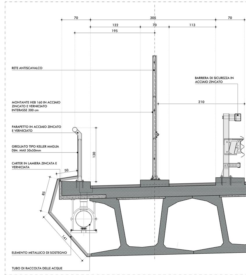
CONFIGURAZIONE RETE ANTISCAVALCO SIMULAZIONE - PROSPETTO
