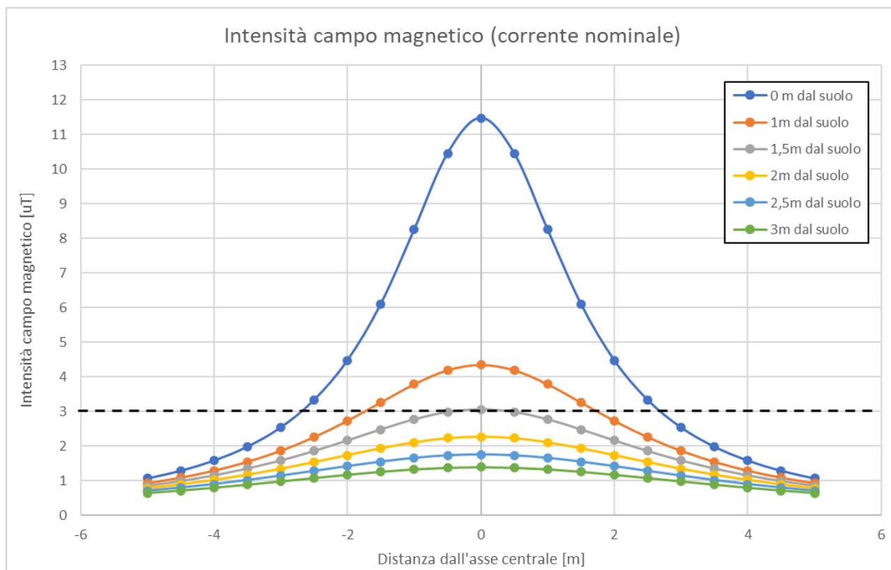
Si può osservare come nel caso peggiore, ovvero considerando un'altezza dal suolo pari a 0, il valore di  $3 \mu\text{T}$  è raggiunto ad una distanza inferiore a 2.5 m dall'asse del cavidotto. Si considera quindi una DPA pari a 3m per l'opera in analisi.
