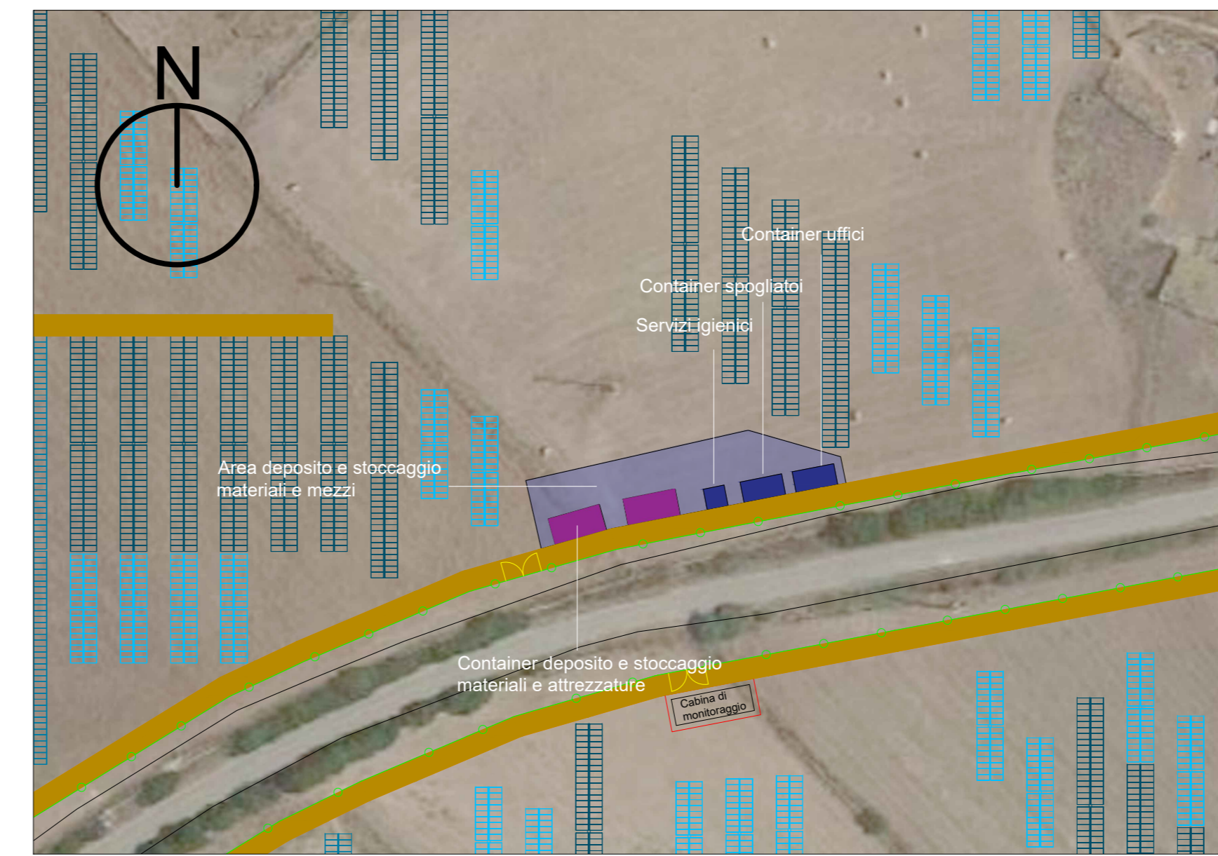
Particolare 3 aree cantiere - Scala 1:1000
