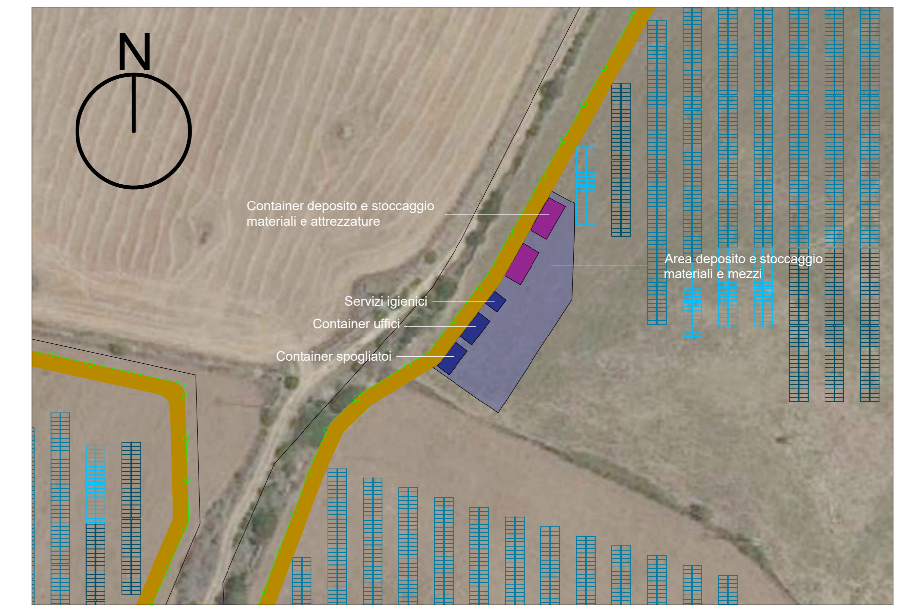
Particolare 4 aree cantiere - Scala 1:1000
