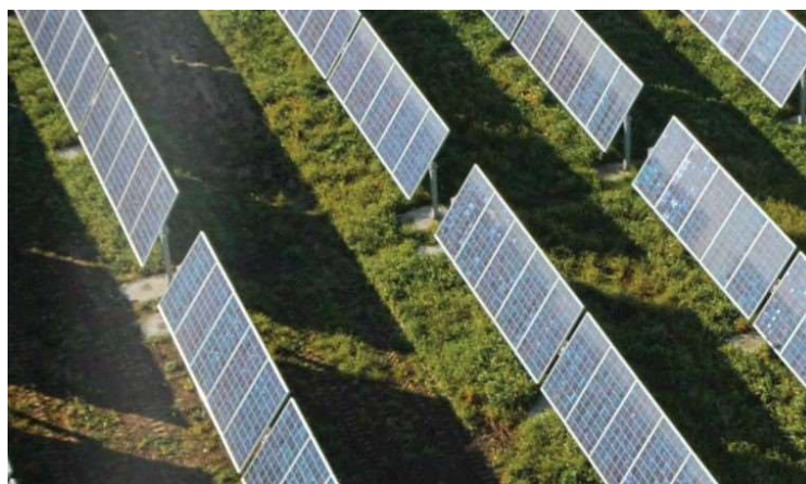
FIGURA 19 - FOTO TIPO TRACKER AD ASSE VARIABILE
