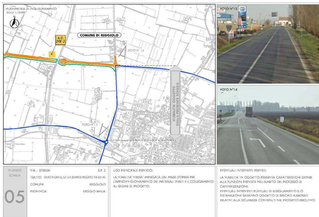
FIGURA 3-11 – ESEMPIO DI SCHEDA DI CENSIMENTO DELLA VIABILITÀ UTILIZZATA IN FASE DI CANTIERE
