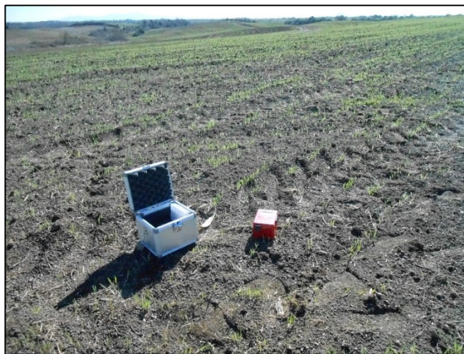
TR1: Acquisizione sismica effettuata nell'area interessata dall'impianto
