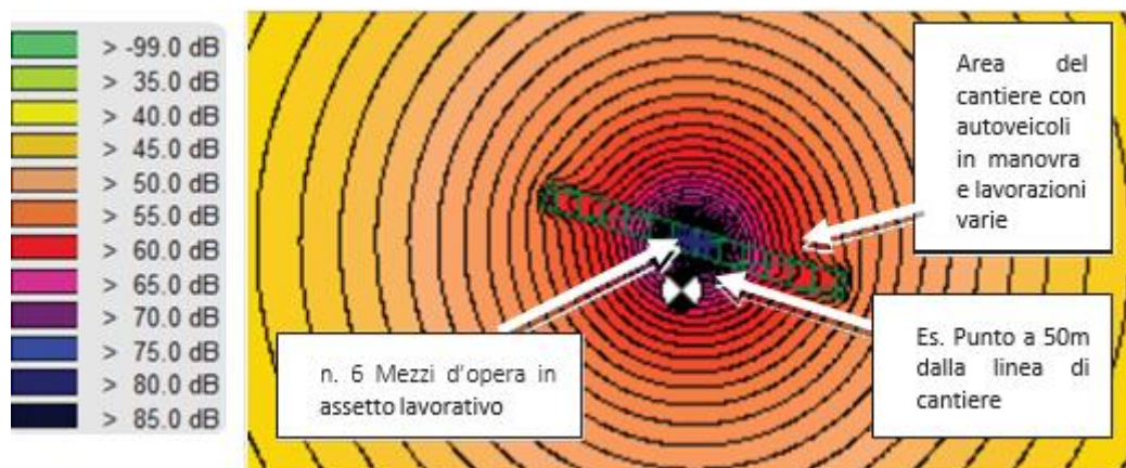
Figura 8-5: Rappresentazione grafica dell'emissione del cantiere – Curve di ISOLIVELLO dB(A)
