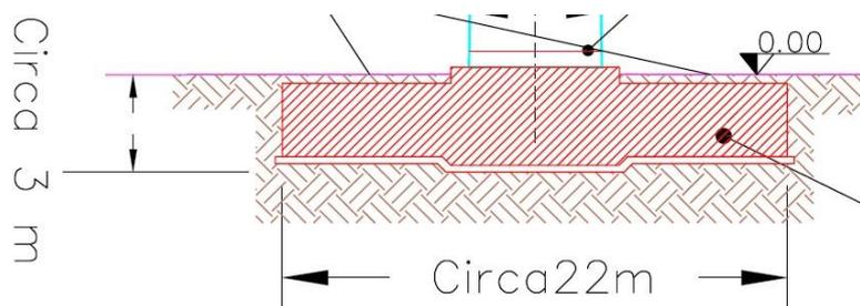
Per poterla realizzare sarà pertanto necessario eseguire uno scavo di pianta circolare di circa 24 m di diametro, con pendenza delle sponde di circa 60° e profondità massima di circa 3 m.
