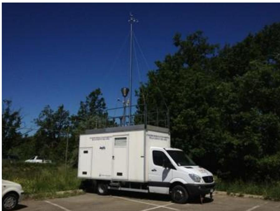
Figura 7.2: Monitoraggio della qualità dell'aria mediante stazione mobile
