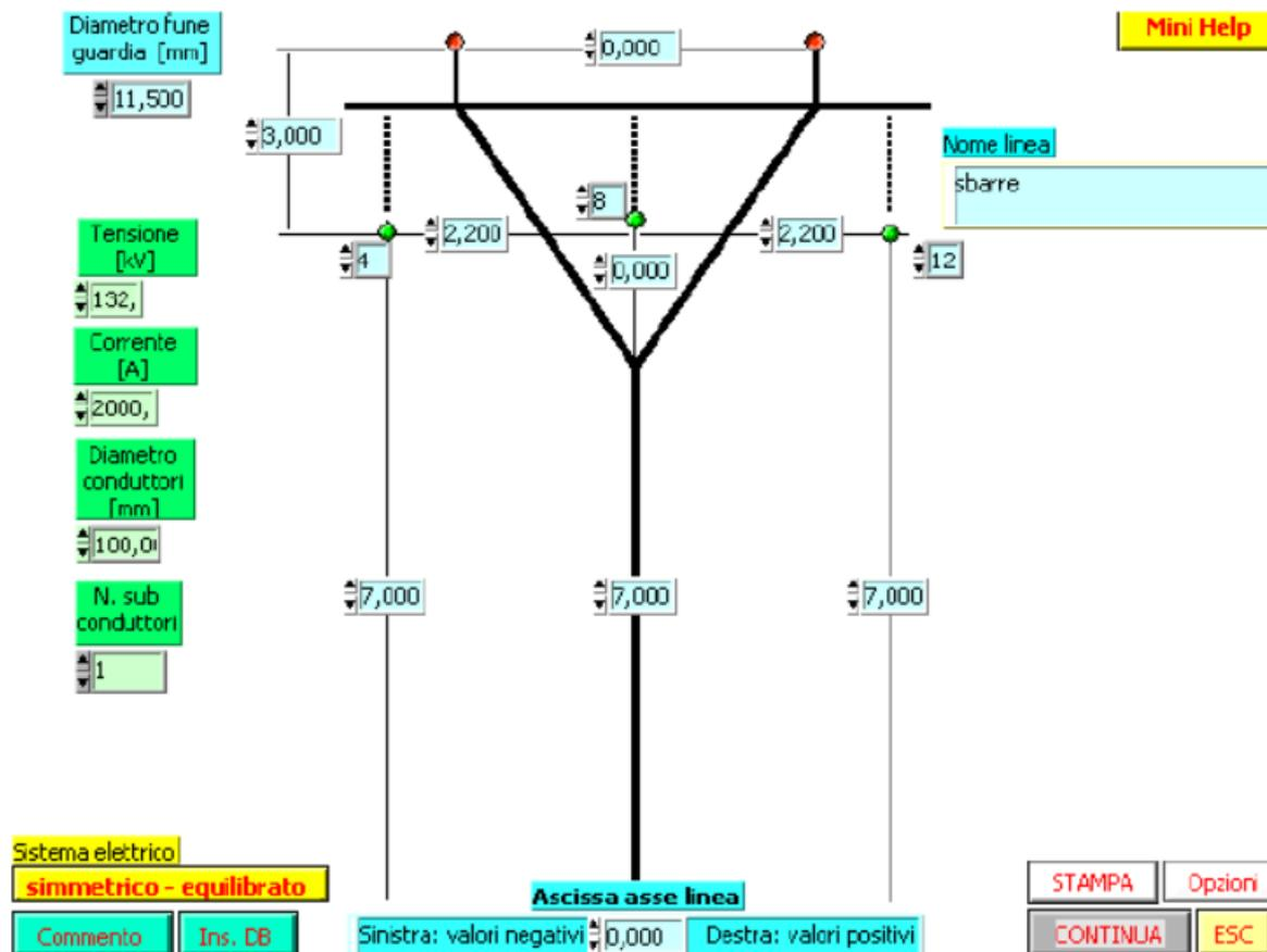
*Linea AT con disposizione conduttori in piano assimilabile ad un sistema semplice sbarra a 132 kV*
