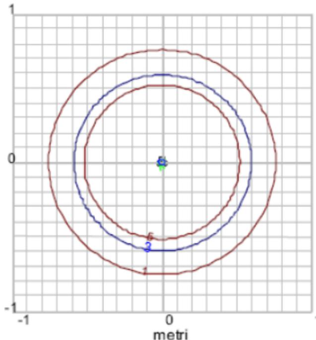
*Curve di equilivello per il campo magnetico di una linea MT in cavo elicordato interrata (dalla Norma CEI 106-11)*
