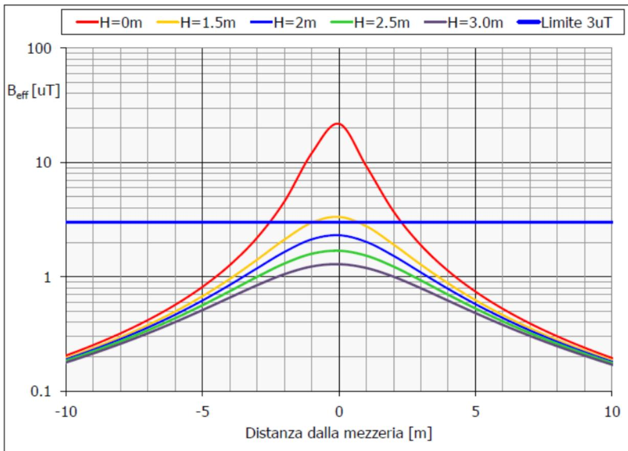
*Andamento dell'induzione magnetica prodotta dalla linea in cavo per la massima corrente del cavo*
