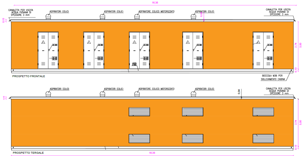
Figura 3-13: prospetti Cabina di Raccolta e Controllo
