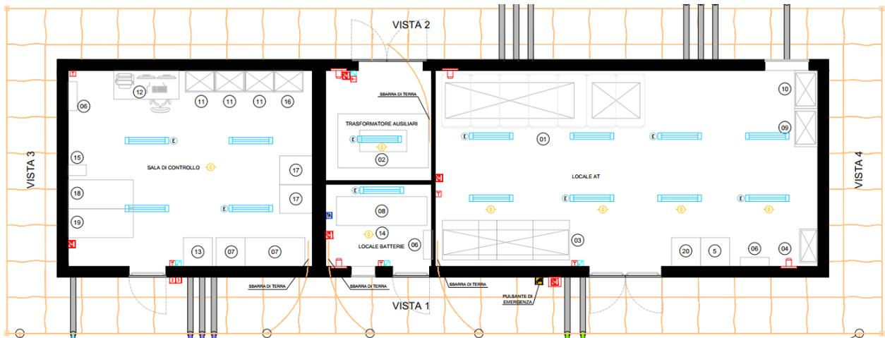
*Figura 4.4 - Posizionamento plafoniere nella cabina AT.*
