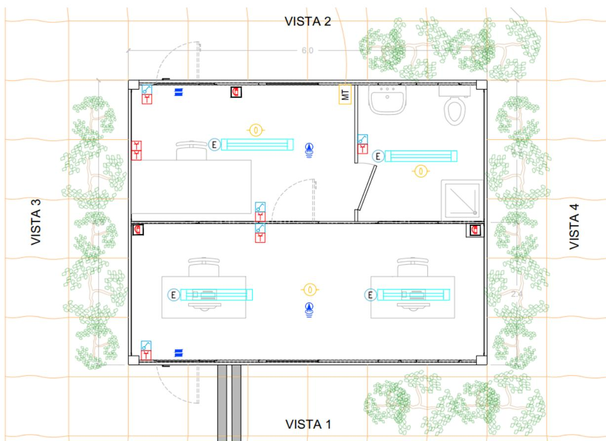
Figura 4.2 - Posizionamento plafoniere Cabina Uffici
