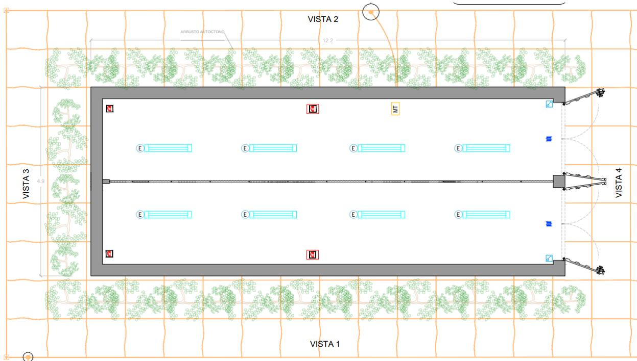
*Figura 4.3 - Posizionamento plafoniere Magazzino.*
