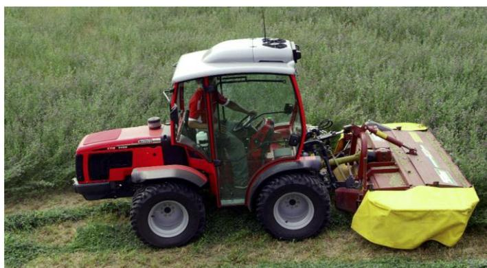
Figura 6.8: Esempio di falciacondizionatrice interceppo posteriore (Foto: Bellon)
