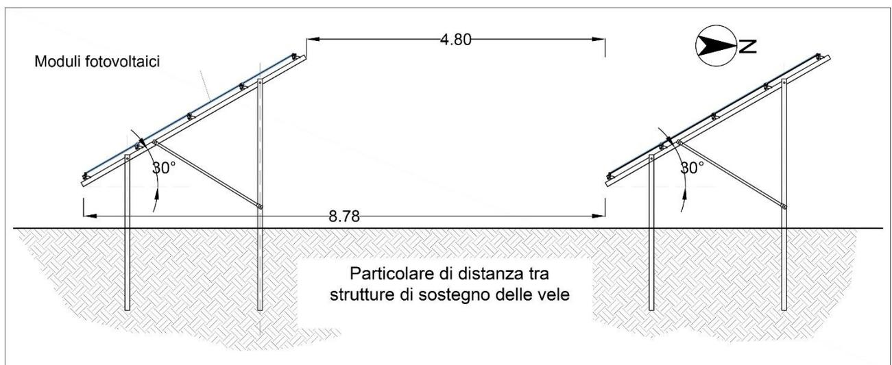
Figura 2-Dettaglio della struttura di sostegno dei pannelli e della distanza tra le file
