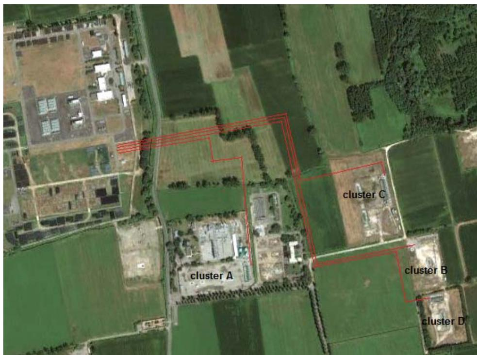
**Figura 4.3.d – Tracciato indicativo dei nuovi collettori di collegamento cluster A, B, C e D-nuovo Impianto di trattamento (base Google Earth)**
