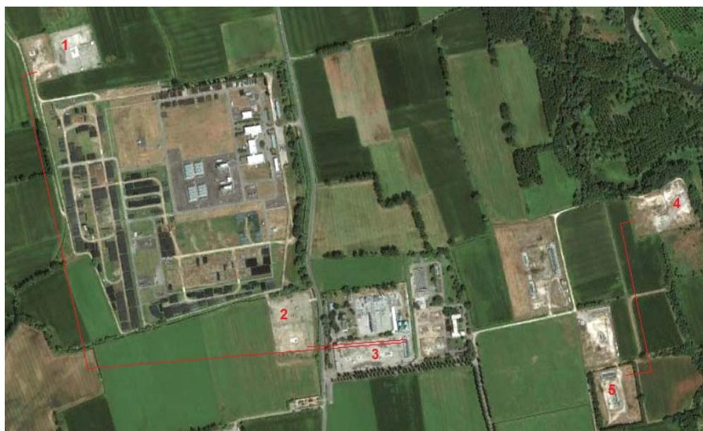
**Figura 4.3.e – Tracciato indicativo delle nuove condotte di collegamento nuovi pozzi-cluster A e D: (1) area pozzi Ripalta 6-62 e nuovo pozzo Ripalta 65Or; (2) area pozzi Ripalta 5-32-63 e nuovo pozzo Ripalta 64dir; (3) cluster A; (4) area pozzi Ripalta 27-61 e nuovi pozzi Ripalta 66Or e 67Or; (5) cluster D (base Google Earth)**
