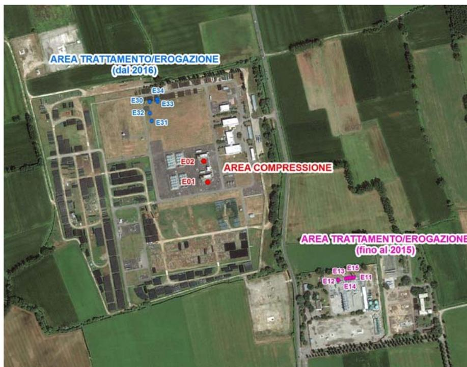
**Figura 5.3.c – Centrale Stogit di Ripalta: ubicazione dei punti di emissione considerati**
