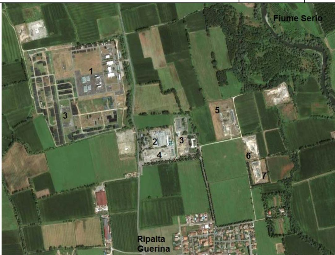
**Figura 3.1.a – Principali infrastrutture della Concessione Ripalta Stoccaggio – situazione impiantistica attuale (base: Google Earth): (1) impianto (area) di compressione; (2) attuale impianto (area) di trattamento; (3) aree Snam Rete Gas; (4) cluster A; (5) cluster C; (6) cluster B; (7) cluster D**
