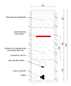
Il collegamento è realizzato mediante cavi ARE4H5E 18/30 kV 3X1X300 mmq, disposti prevalentemente a "trifoglio".
