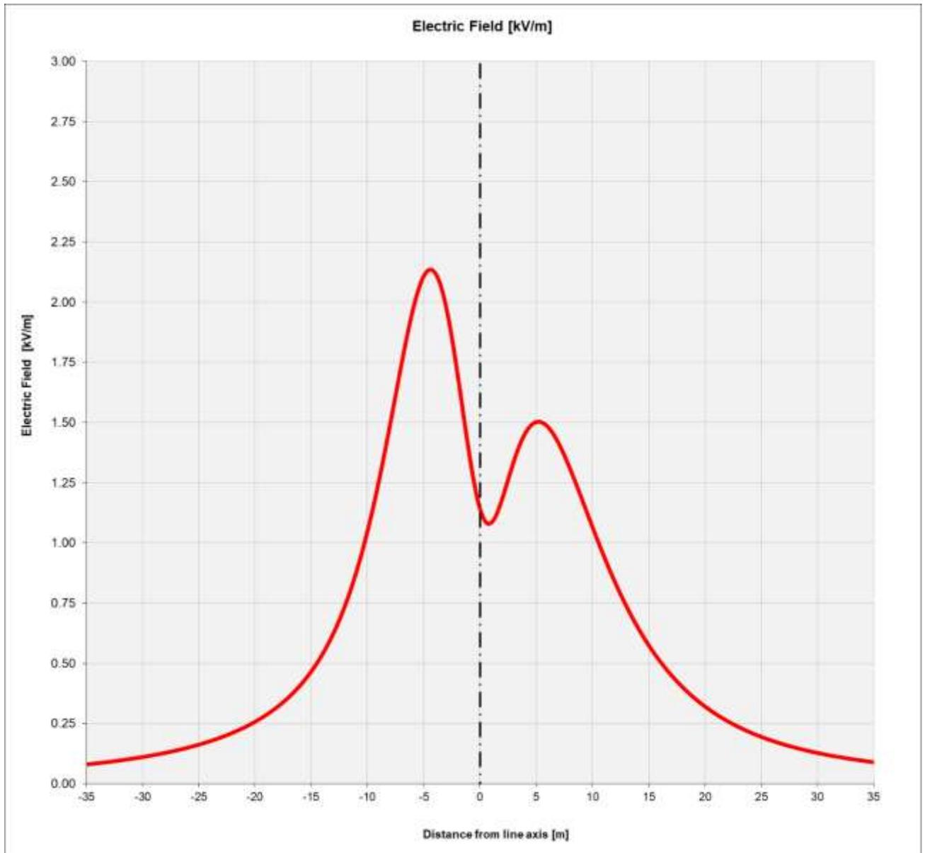
**Fig. 3: andamento del campo elettrico in una sezione perpendicolare all'asse linea, calcolato ad 1,5 m dal suolo**
