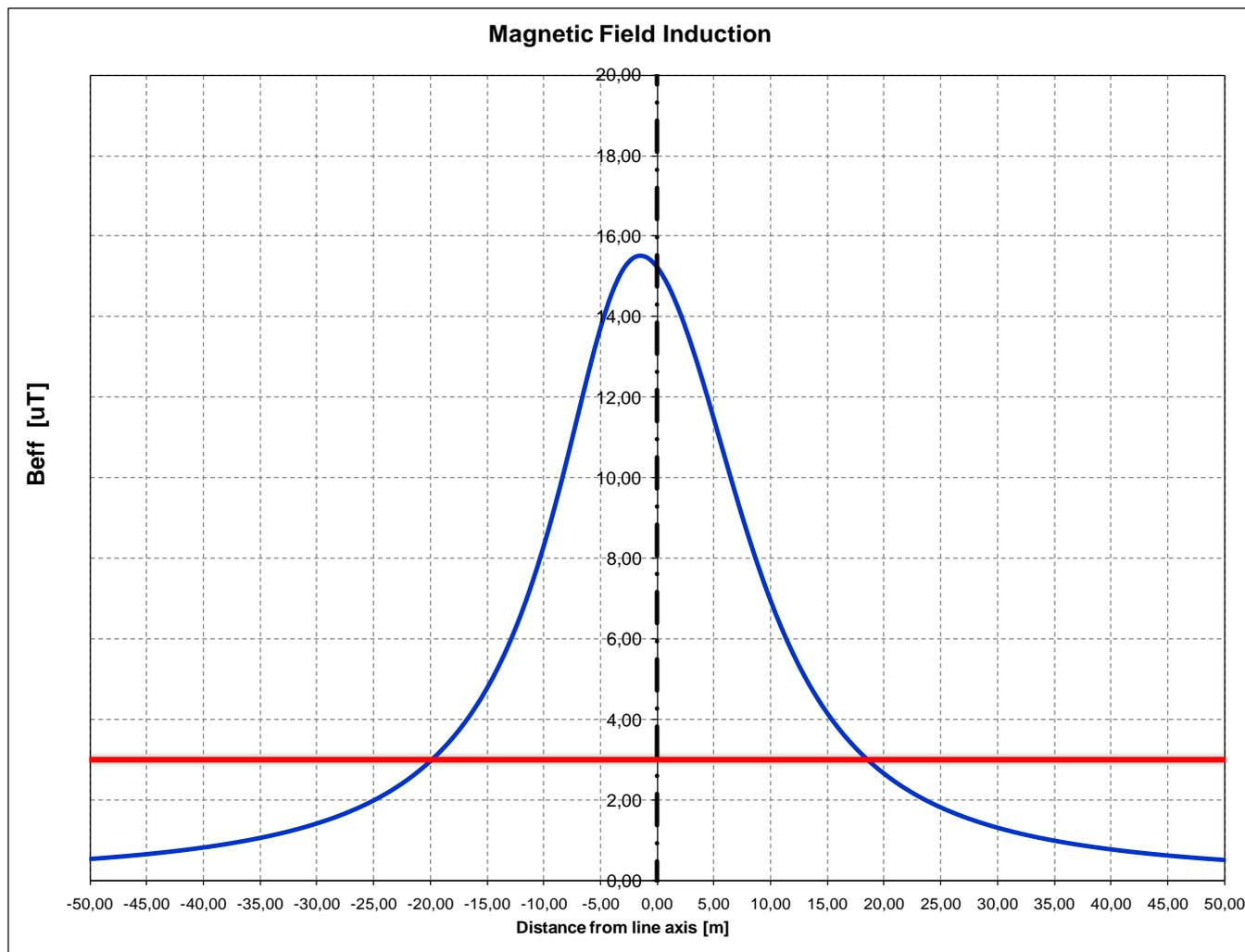
**Fig. 2: andamento dell'induzione magnetica in una sezione perpendicolare all'asse linea, calcolata a 1,5 m dal suolo in caso di franco minimo (obiettivo di qualità pari a 3  $\mu T$ )**
