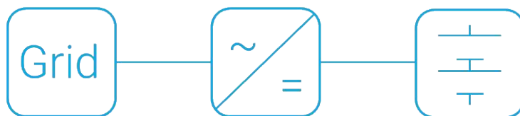
Figura 8.3-5 Schema semplificato di un convertitore monostadio
