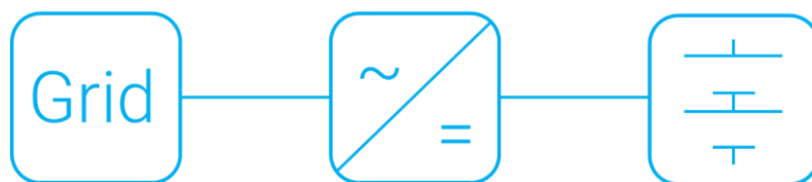
Figura 8.3-5 Schema semplificato di un convertitore monostadio
