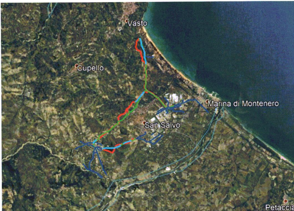
Fig. 1 - Inquadramento degli interventi su foto aerea: in rosso le opere in progetto ed in verde quelle da dismettere, in blu i metanodotti in esercizio. (cfr. "Studio Preliminare Ambientale", file: 20401-RT-SIA-001_r1, p.11)
