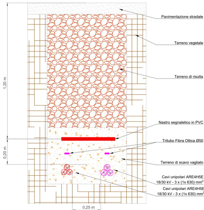
POSSIBILE PARTICOLARE DI POSA DEL CAVIDOTTO AT
