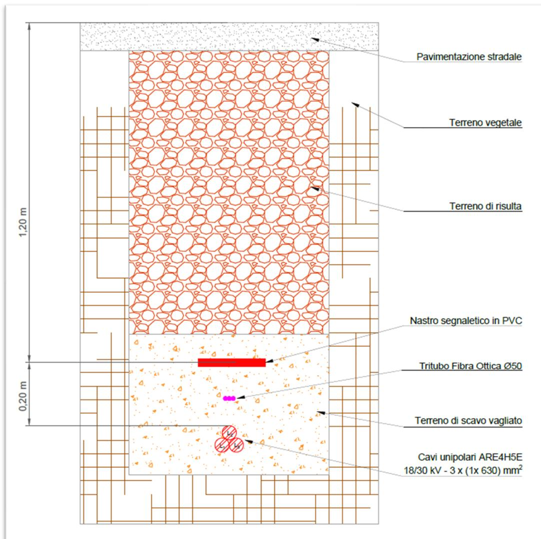
**Figura 4: particolare di posa dorsale MT di collegamento con la SSE utente – Sotto-sezione Nord - singola terna di cavi da 630 mm<sup>2</sup> profondità di posa 1,40 m**
