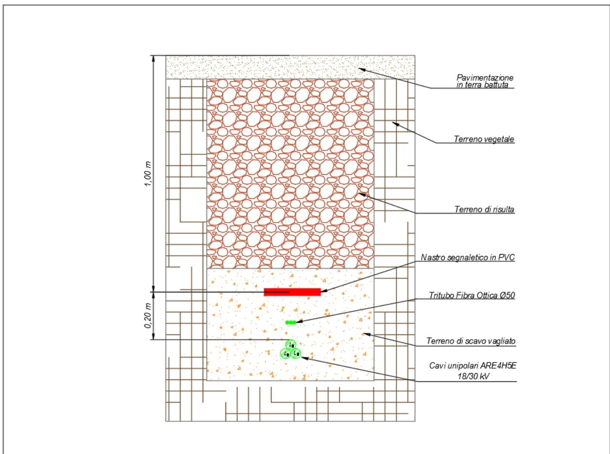
**Figura 9: particolare di posa linee MT di campo**
