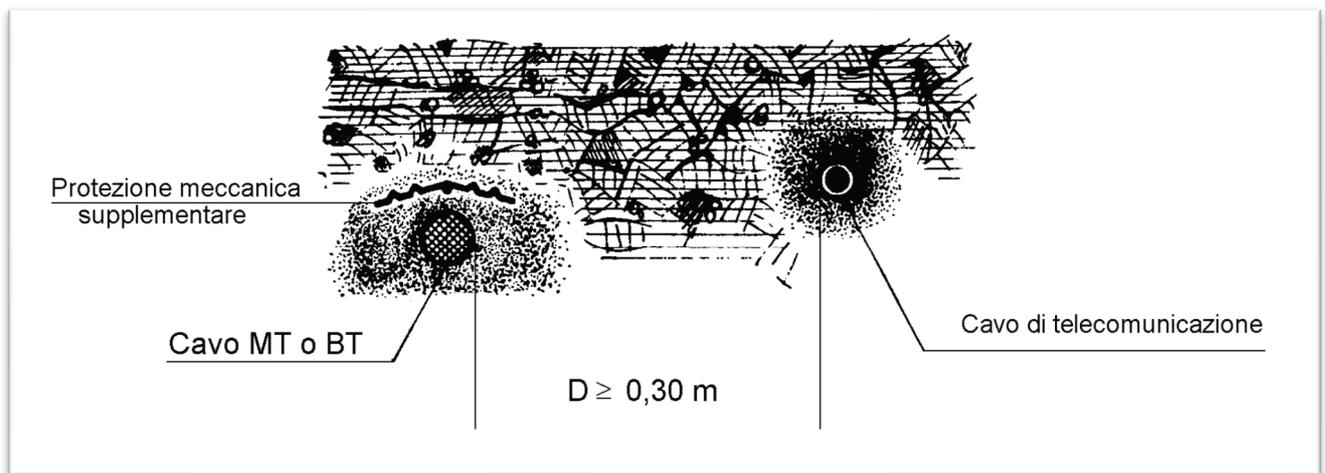
*Figura 10: Distanze di sicurezza da mantenere in presenza di interferenze con linee di telecomunicazione – cavi di energia posati direttamente nel terreno*
