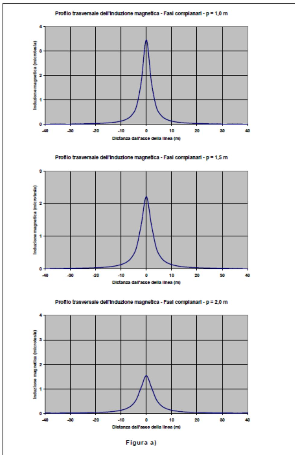
*Figura 6: induzione magnetica generata da linee trifasi con conduttori distanziati tra loro di 0,20 m posati rispettivamente a 1,00 m, 1,50 m e 2,00 m di profondità, paralleli tra loro e alla superficie di calpestio. La corrente di ogni fase è di 200 A – Norma CEI 11-17*
