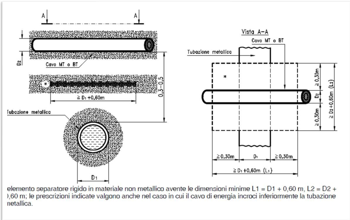
*Figura 15: distanze di sicurezza in presenza di interferenze con tubazioni metalliche interrato*
