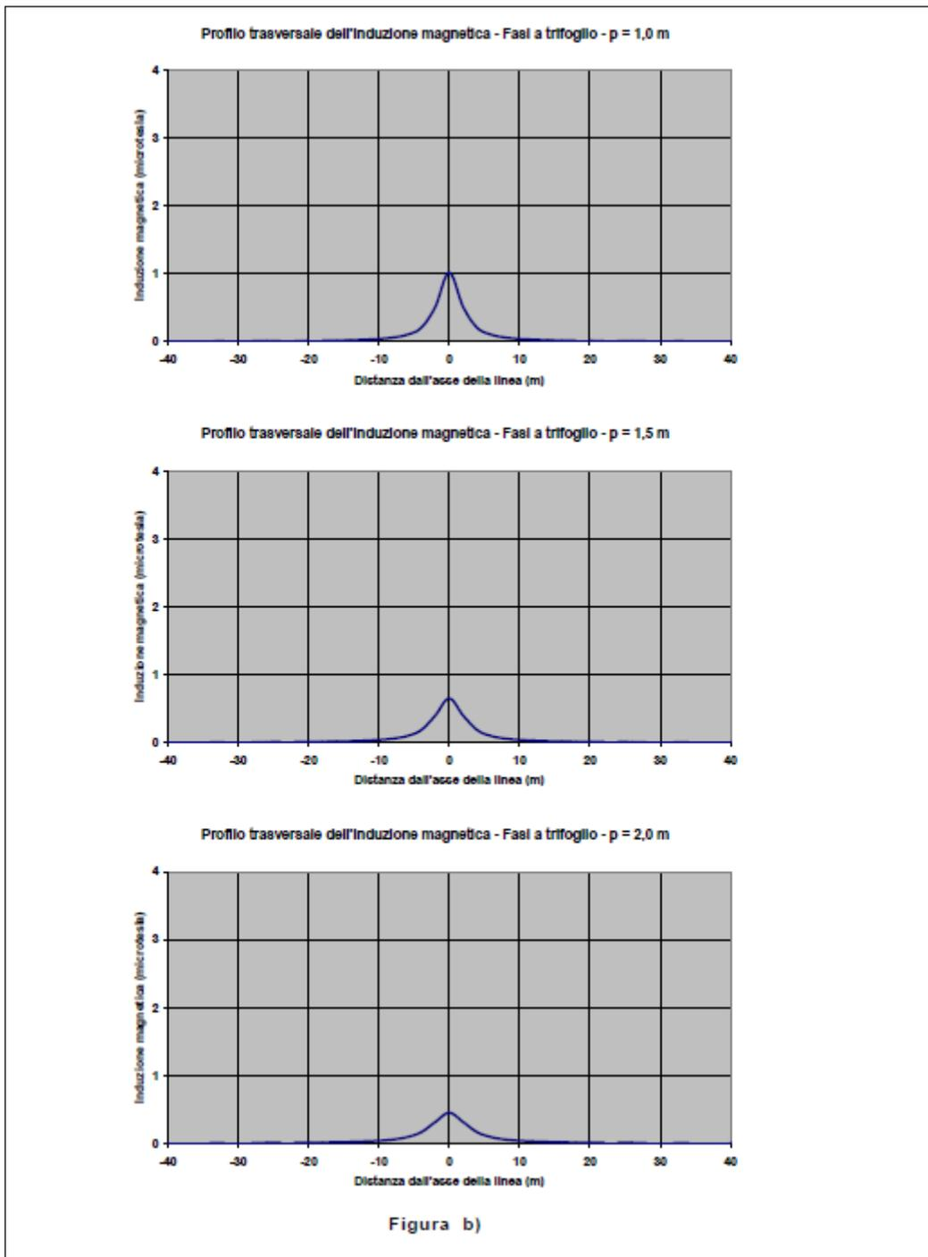
*Figura 7: induzione magnetica generata da linee trifasi con conduttori distanziati tra loro di 0,05 m posati rispettivamente a 1,00 m, 1,50 m e 2,00 m di profondità, paralleli tra loro e alla superficie di calpestio. La corrente di ogni fase è di 200 A – Norma CEI 11-17*
