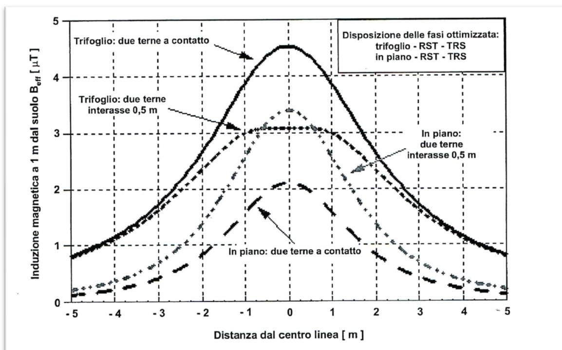
*Figura 8: confronto tra i profili laterali dell'induzione magnetica a 1 m da terra di due terne posate rispettivamente a trifoglio e in piano a contatto,  $I = 1000$  A, profondità di posa = 1,20 m, diametro dei cavi 100 mm*
