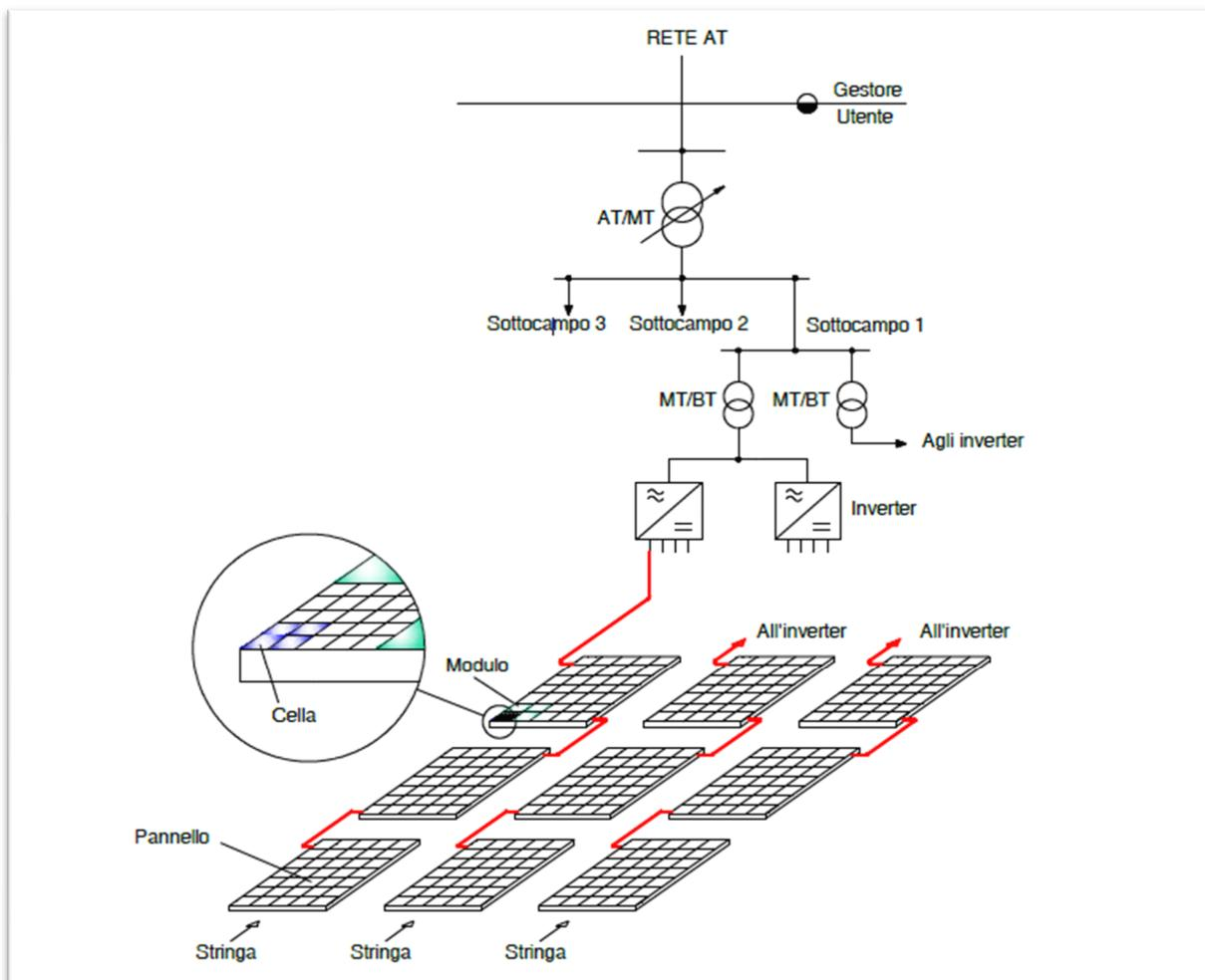
*Figura 2: Composizione tipica di una Centrale Fotovoltaica*
