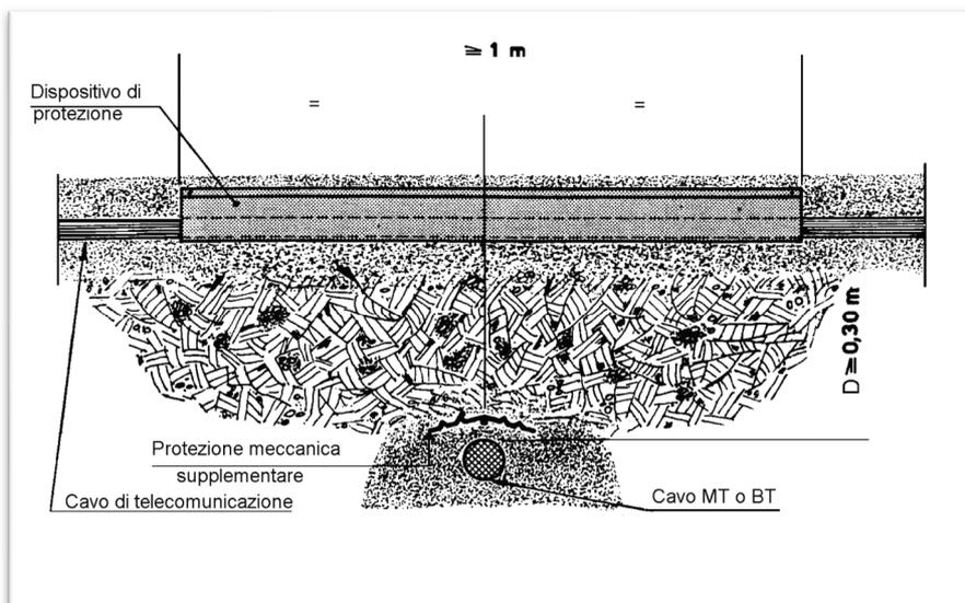
**Figura 12: distanze di sicurezza da mantenere in presenza di parallelismi – cavi di energia posati direttamente nel terreno**
