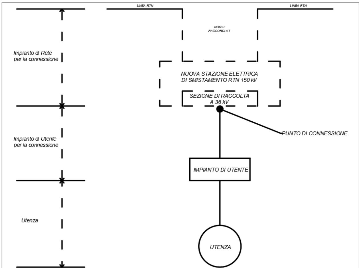
**Figura 3: Schema di principio Nuovo Standard di connessione a 36 kV**
