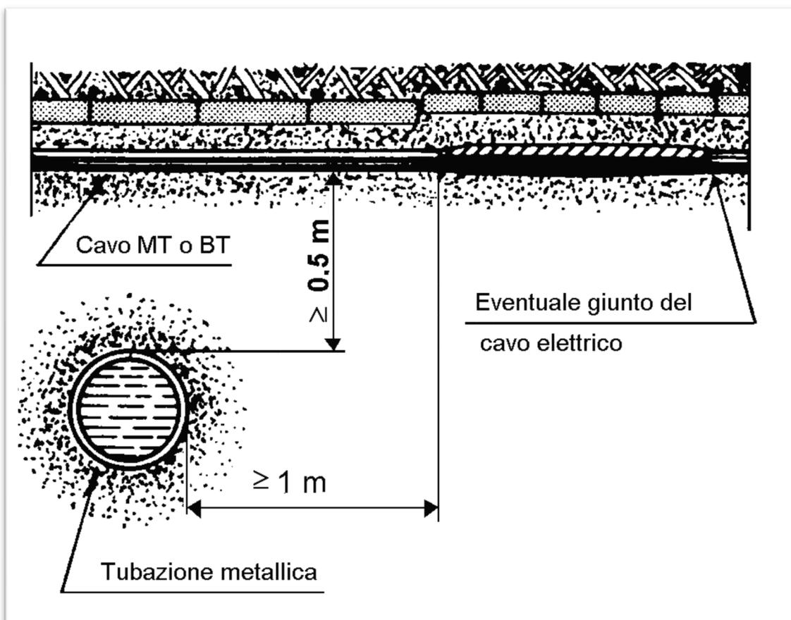
*Figura 14: distanze di sicurezza in presenza di interferenze con tubazioni metalliche interrate*
