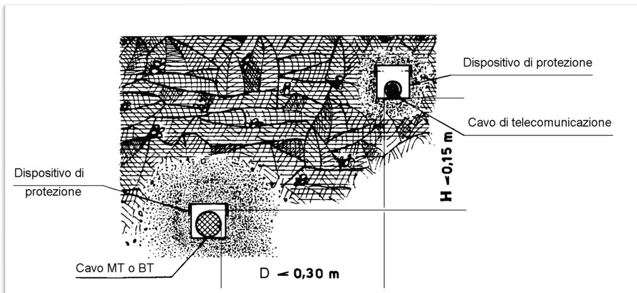
*Figura 11: distanze di sicurezza da mantenere in presenza di interferenze con linee di telecomunicazione – cavi di energia dotati di protezione meccanica*
