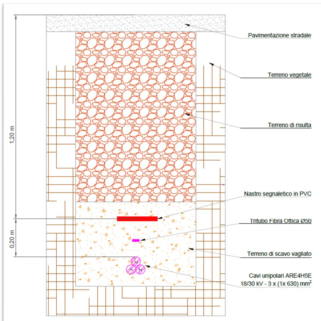
**Figura 5: particolare di posa dorsale MT di collegamento con la SSE utente – Sotto-sezione Sud - singola terna di cavi da 630 mm<sup>2</sup> profondità di posa 1,40 m**
