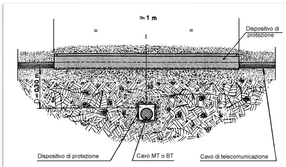
**Figura 13: distanze di sicurezza da mantenere in presenza di parallelismi – cavi di energia dotati di protezione meccanica**
