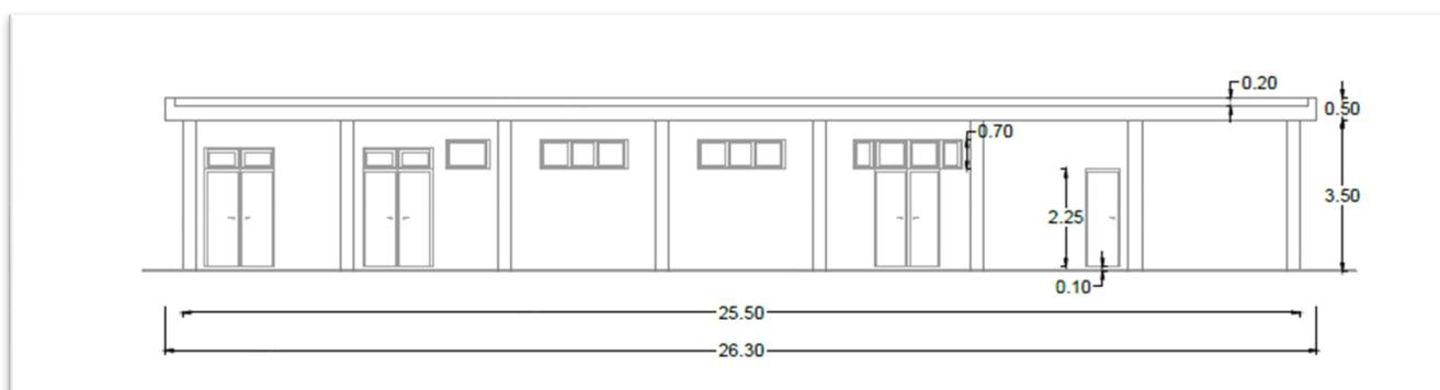
*Figura 11: Prospetto locale tecnico della Sottostazione Elettrica di Utenza*
